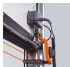
Om uw veiligheid bij een sectionaaldeur met loopdeur zonder sokkel te verhogen, adviseren wij de toepassing van de optionele voorlopende fotocel VL 2.
